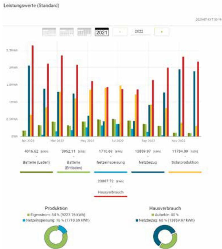
Abbildung 3: Musteranlage 1 Energieflüsse 01/2022 – 12/2022
